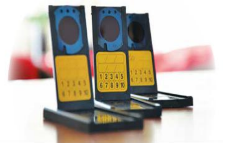
Dosimètre utilisé pour l'étude Quantiradon Le dosimètre KODALPHA est conçu, fourni et analysé par le laboratoire DOSIRAD (ALGADE/ Groupe CARSO)
